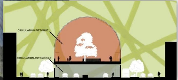
*Protection des piétons contre les nuisances grâce à la réalisation d'une plateforme couverte au-dessus de la voie centrale
